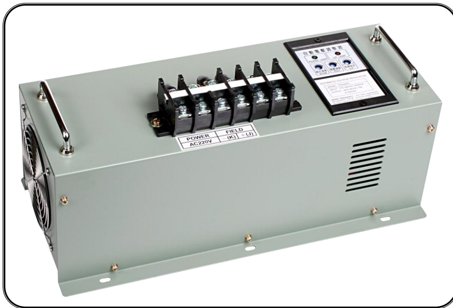
75 Amp AVR 适用于自励式炭刷式发电机 EA75A220HL (半波) / EA75A220FL (全波) *另有可并网机种可选择
